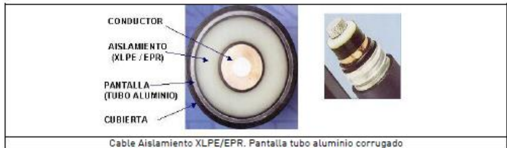
Cable Aislamiento XLPE/EPR. Pantalla tubo aluminio corrugado
