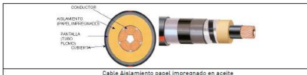
Cable Aislamiento papel impregnado en aceite
