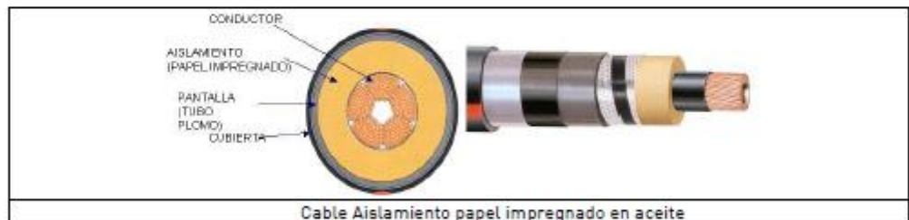
Cable Aislamiento papel impregnado en aceite
