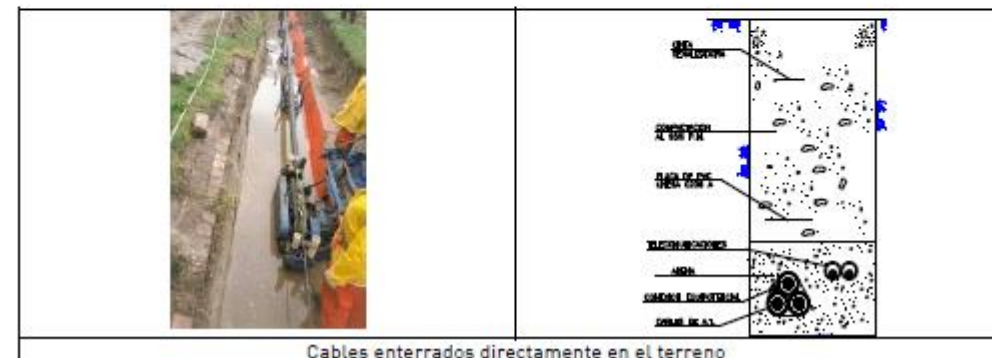
Cables enterrados directamente en el terreno
